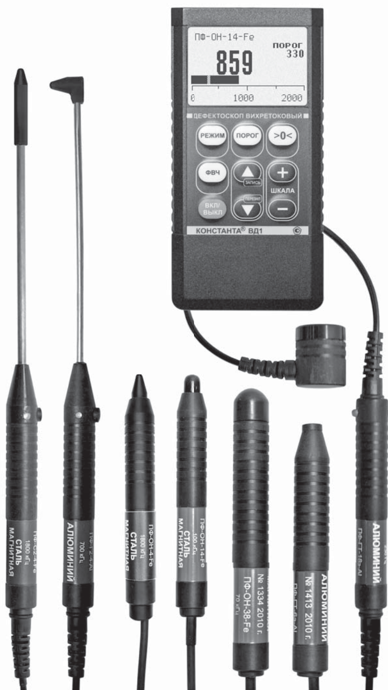
Внешний вид измерительного блока «Константа ВД1» и преобразователей
